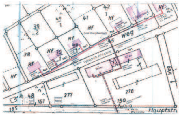
Grafik: WIB Wirtschafts- und Ingenieurberatungsgesellschaft mbH, Kuhlowitz (PM): Auszug aus dem Nahwärmenetz Rädigke, gespeist aus der Biogas-Anlage.
