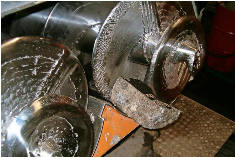
Bruchstücke eines granitenen Grabsteins haben sich in der Schnecke des Presswerkes verklemmt.
