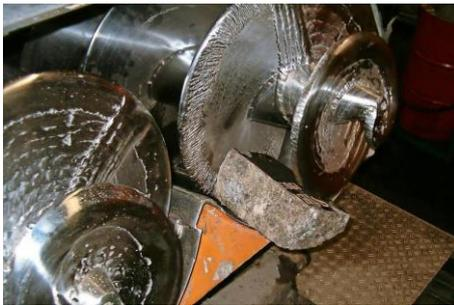
So ist es nicht ausgeschlossen, dass Vorrichtungen zur Verdichtung des Mülls im Sammelfahrzeug beschädigt werden. Zudem nehmen die Tonnen Lasten auf, für die sie nicht gemacht sind. Sind die Tonnen zu schwer, können diese bei der Leerung abrutschen und dadurch eine Gefahrenquelle darstellen.
