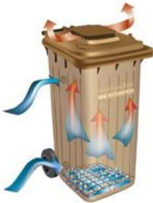
Zitat: "Die intensive Durchlüftung (des Compostainers ®CT) sorgt für hohe Sauerstoffzufuhr des Sammelgutes. Hierdurch wird die Aktivität der im Bioabfall enthaltenen Mikroorganismen gefördert, die für den aeroben Materialabbau sorgen.
